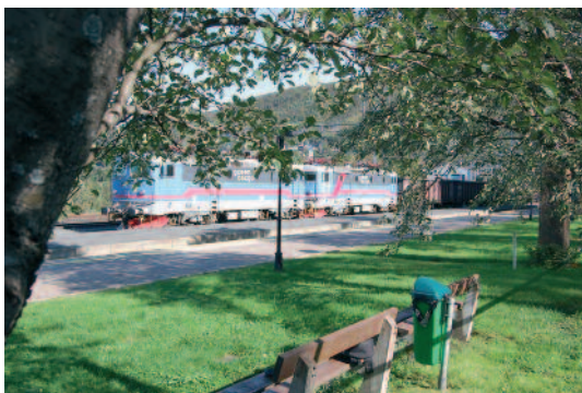
Malmtog som frakter jernmalm for det nye selskapet Northland Resources, et kanadisk gruveselskap som tar ut malm i Kaunisvaara i Nord-Sverige. Dette selskapet startet utskipning av jernmalm over Narvik i 2013. LKABs malmtog er på 750 m. og det kreves derfor lange dobbeltsporet møteplasser for at trafikken kan avvikles.
